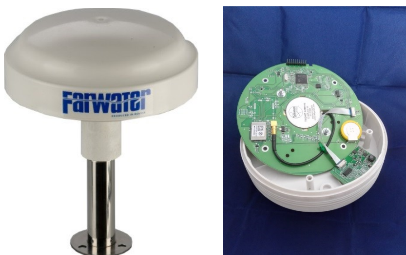
Рисунок 1 – Пример конструктива смарт-датчика ГНСС
